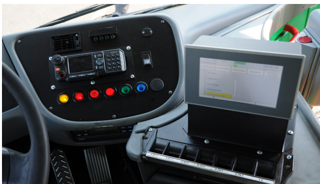
Moderne Bordrechner informieren die Fahrer und steuern die gesamte Fahrzeugperipherie in allen Fahrzeugen.
