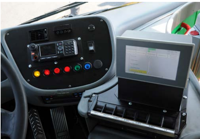
Moderne Bordrechner informieren das Fahrpersonal und steuern die gesamte Fahrzeugperipherie in allen Fahrzeugen.
